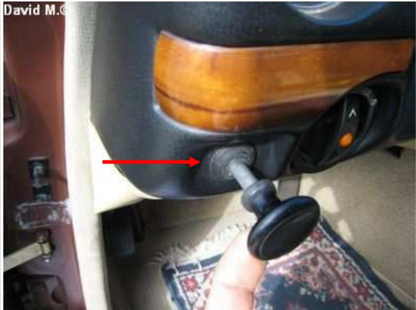
32) Führung der Feststellbremse eingeleitet, Schlitz sichtbar
