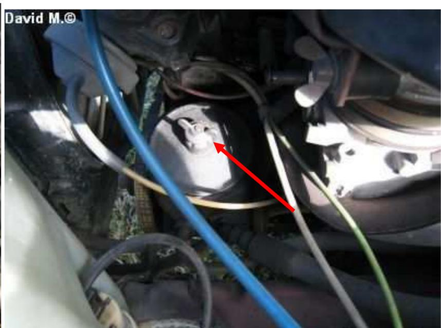
58) Deckel der Servopumpe mit Rändelmutter statt Flügelmutter
