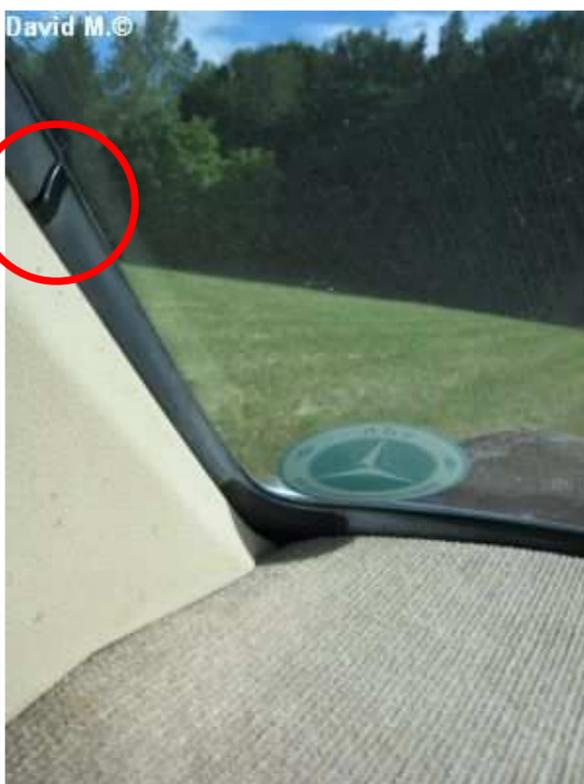
52) beide Kabeln der Heckscheibenheizung nicht als Band in der Mitte, sondern unten; führen unter die Hutablage
