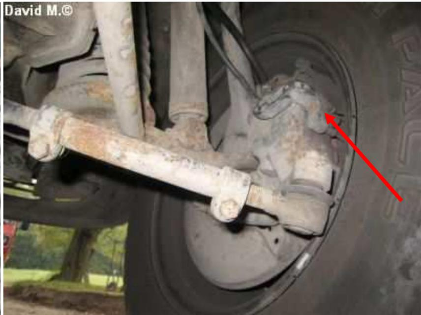
60) andere Verschleißanzeige; Kabel mit Blechhalter am Bremssattel
