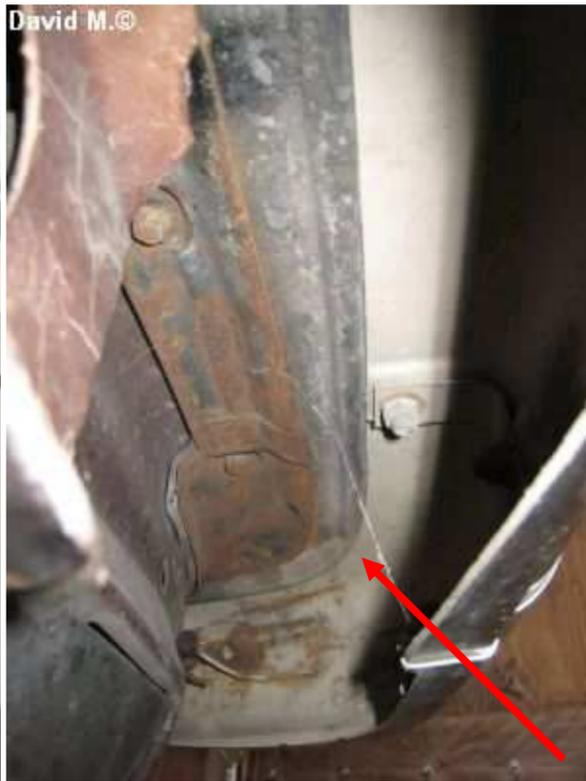
7) Wasserabläufe in den Gummiecken der Stoßstange
